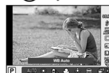
Pendant le réglage des fonctions de prise de vue, si vous appuyez sur la touche , le contrôle en direct s'affiche et vous pouvez sélectionner une fonction en tournant la molette arrière.
