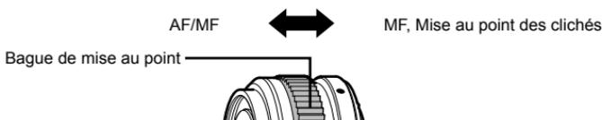
Avec la mise au point des clichés, une distance est définie à l'aide de la bague de mise au point en fonction de la distance de la prise de vue. L'appareil photo effectue la mise au point sur une profondeur de champ qui correspond à la valeur d'ouverture définie.
