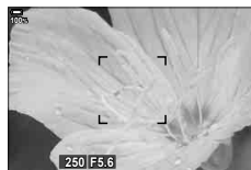
Expozícióbeállítási kijelző az M és B módokhoz
