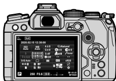
Fényképezés a keresővel (a kijelző kikapcsol, ha a kereső be van kapcsolva)
