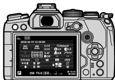
Chụp ảnh khung ngắm (màn hình tắt khi kính ngắm đang bật)
