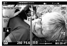
検出した被写体を追尾しているときのターゲット表示
