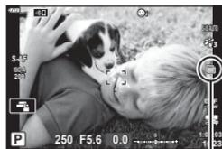
Vorbereitung der Kamera auf hochaufgelöste Aufnahmen läuft (blinkt)
