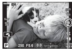
Fotoaparati je pripravljen na posnetek visoke ločljivosti (utripa)
