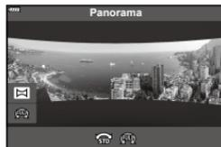
3 Seleccione una dirección de movimiento mediante  $\triangle \nabla \triangleleft \triangleright$  y pulse el botón  $\text{OK}$ .
