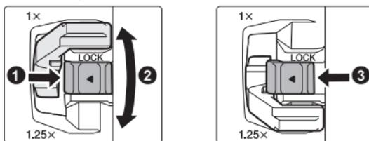
1 Розблокуйте селектор телеконвертора, пересунувши блокування телеконвертора в показаному напрямку (1).
