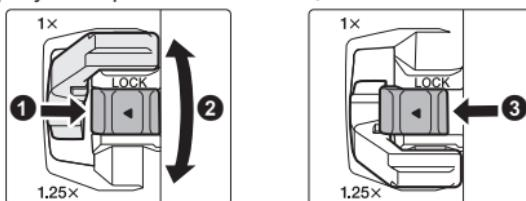
1 Разблокируйте переключатель телеконвертера, сдвинув блокировку телеконвертера в указанном направлении (1).
