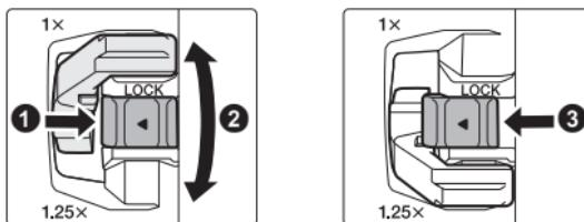
1 按照圖示方向 (①) 滑動遠攝轉換器鎖可解鎖遠攝轉換器選擇器。
