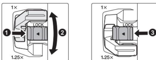
1 Entriegeln Sie den Telekonverterwählschalter, indem Sie die Telekonverterverriegelung in die abgebildete Richtung schieben (1).
