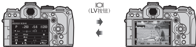
取景器拍摄(取景器启动时显示器自动关闭)
