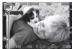
Fotoaparati je pripravljen na posnetek visoke ločljivosti (utripa)
