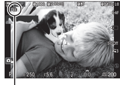
กล้องที่พร้อมสำหรับ High Res Shot (กะพริบ)
