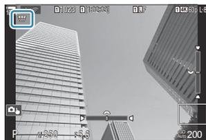
**1.** Cadrez la prise de vue et ajustez la compensation trapézoïdale tout en visualisant votre sujet à l'écran.
