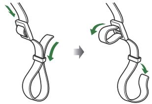
2. Faites passer l'extrémité de la sangle dans l'œillet de fixation de la sangle puis repassez-la dans l'attache de boucle.
