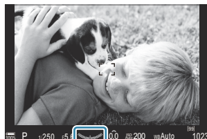
Prikaz, ko je sprožilec pritisnjen do polovice
