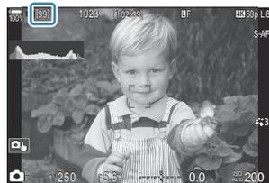
当它变成[00]（红色）时，照相机将无法再拍摄下一张照片。当缓冲区中的图像被写入存储卡时，可存储的照片数量会相应增加，这时便可以拍摄照片了。
