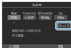
🔗 当传感器流畅度被设为 100 fps 或更快时, 视频将以 100 – 240 fps 的速度拍摄, 以 23.98 – 59.94 fps 的速度播放。将播放时间拉伸到 2 至 10 倍, 即可以慢动作观看被摄对象的瞬时移动。
