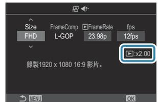
🔔 當感應器幀率設為 120 fps 時，將以 120 fps 的幀率拍攝短片，並以 23.98 - 59.94 fps 的幀率播放。拉伸播放可使錄製時間增至 2-5 倍，這可讓您以慢動作觀看現實生活中的瞬間動作。
