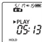
Im Display wird **[HOLD]** angezeigt und der Rekorder schaltet in den HOLD-Modus.
